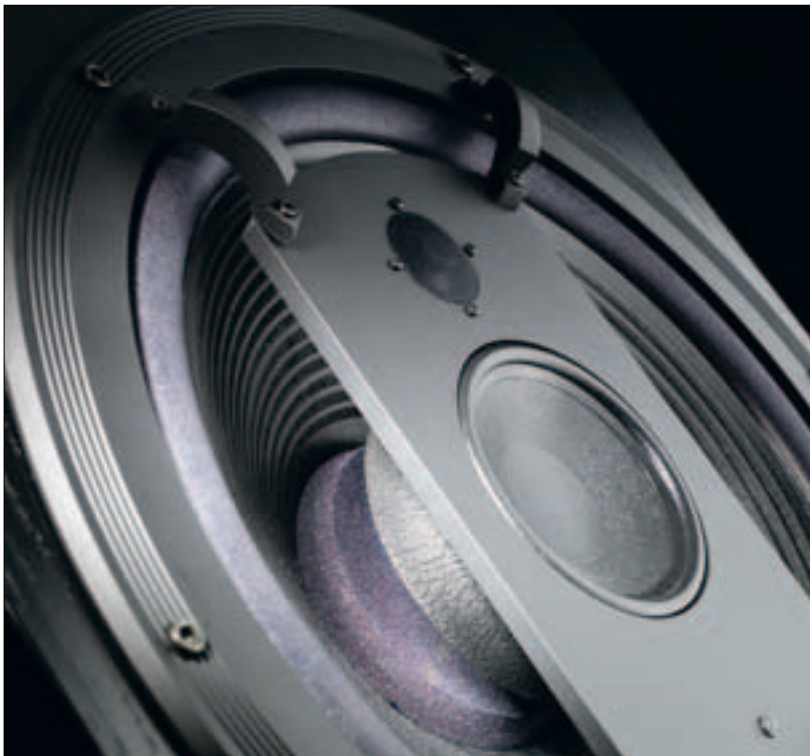
Freimaurer: Für höchste Verfärbungsfreiheit ist der Mitteltoner offen in die Schallwand eingebaut – ein rückseitiger Ring mit justierter Dämpfung verhindert den akustischen Kurzschluss.
